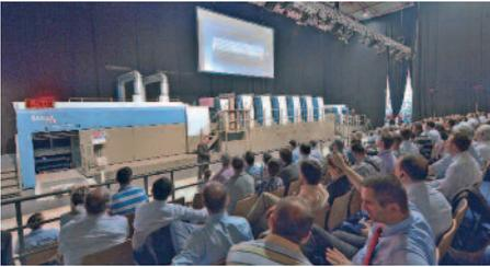
Die Rapida 164 wurde beim Open House als Sechsfarbenmaschine mit Lackturm, Einzelantriebstechnik und umfangreicher weiterer Automatisierung wie etwa Stapellogistik gezeigt.
