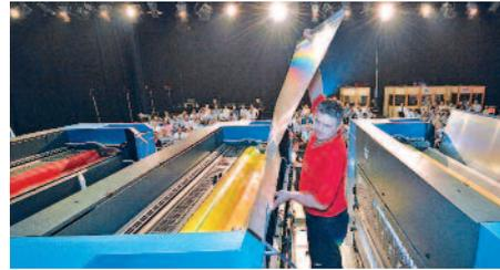
Angesichts der häufigen Jobwechsel mit Drive Tronic SPC bei der Vorführung kam Hendrik Gasch mit dem Bestücken der Wechselschächte mit den Druckplatten für den Folgeauftrag kaum nach.
